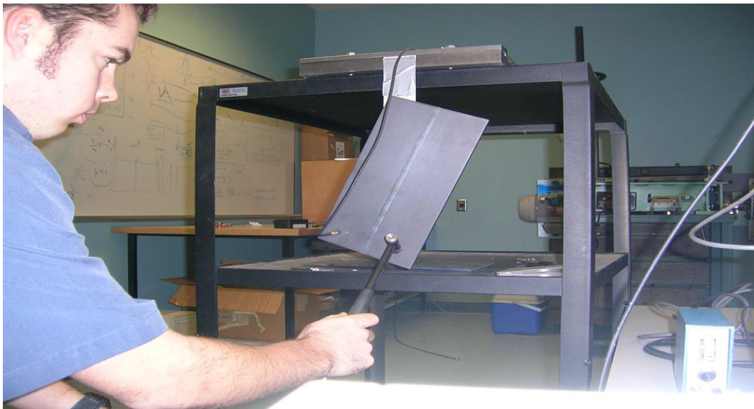
Figure 1 : analyse modale d'une plaque libre-libre par technique d'impact
