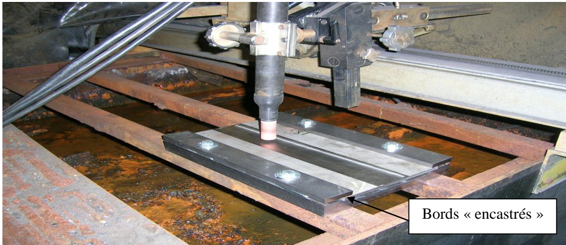
Figure 2 : Montage de la plaque pour le soudage
