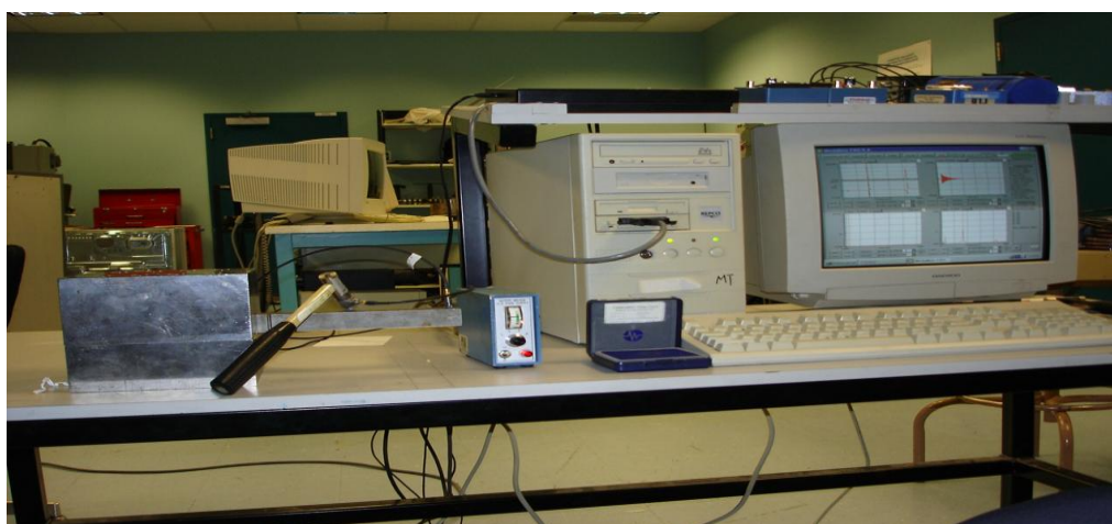
Figure 9: Chaîne de mesure pour l’analyse modale expérimentale
