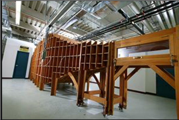
La soufflerie subsonique Price-Païdoussis du LARCASE.
