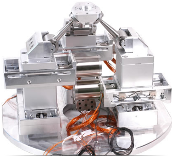
FIGURE 10 – SPACEFAB, UN MICRO-POSITIONNEUR (MICOS)
