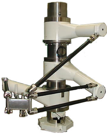
FIGURE 15 – UN ROBOT DE LA FAMILLE GANTRY-TAU (ABB)
