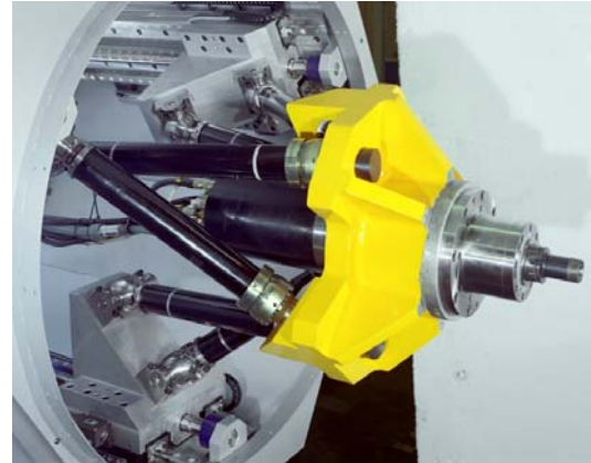
FIGURE 12 – HERMES, UNE MACHINE-OUTIL À 3 AXES (FATRONIK)
