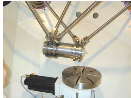
FIGURE 11 – HSC, UNE MACHINE OUTIL À 5 AXES (METROM)
