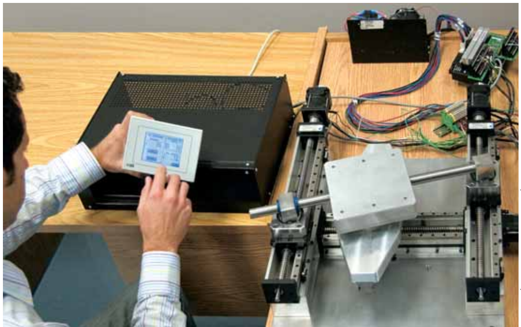
Robot de positionnement précis permettant d'atteindre des coordonnées dans l'espace à une vitesse ultrarapide.
