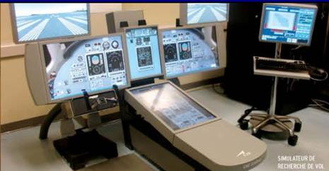
Simulateur de vol pour la recherche niveau D
